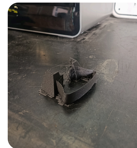
Exemple d'aileron imprimé en LW PLA
